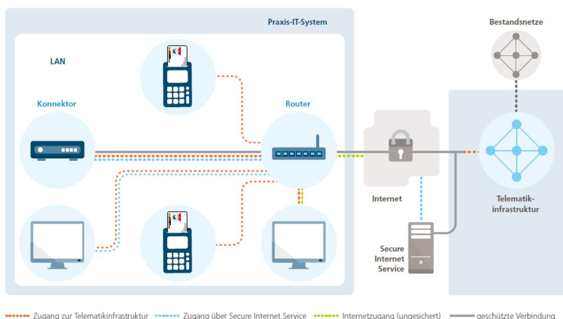
**Abbildung 17: Schematische Darstellung der parallelen Anbindung**
