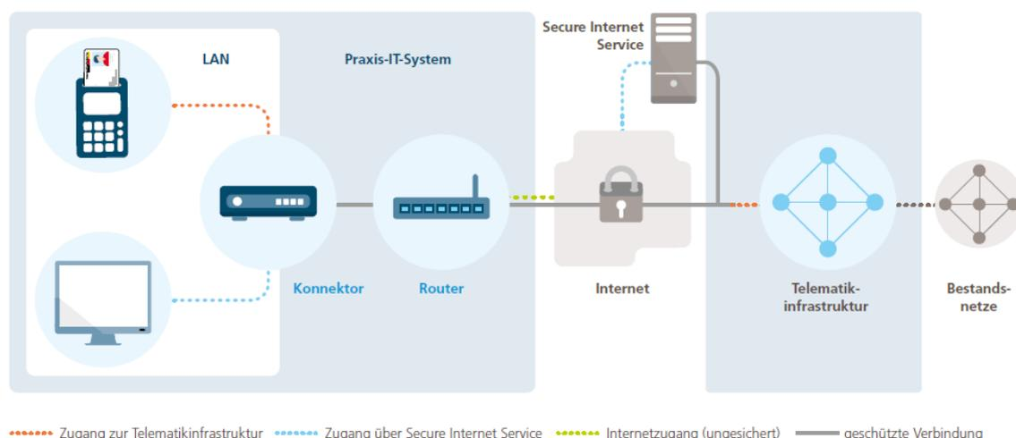
**Abbildung 16: Schematische Darstellung der seriellen Anbindung**
