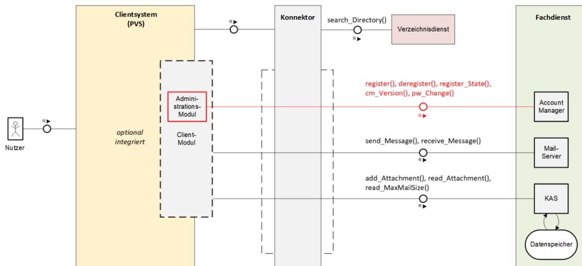
**Abbildung 9: Systemkomponenten KIM (Quelle: [gemSpec\_CM\_KOMLE])**
